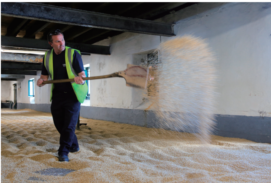
ラフロイグのフロアモルティング（自家製麦）。 職人が木のシャベルですき返す。
