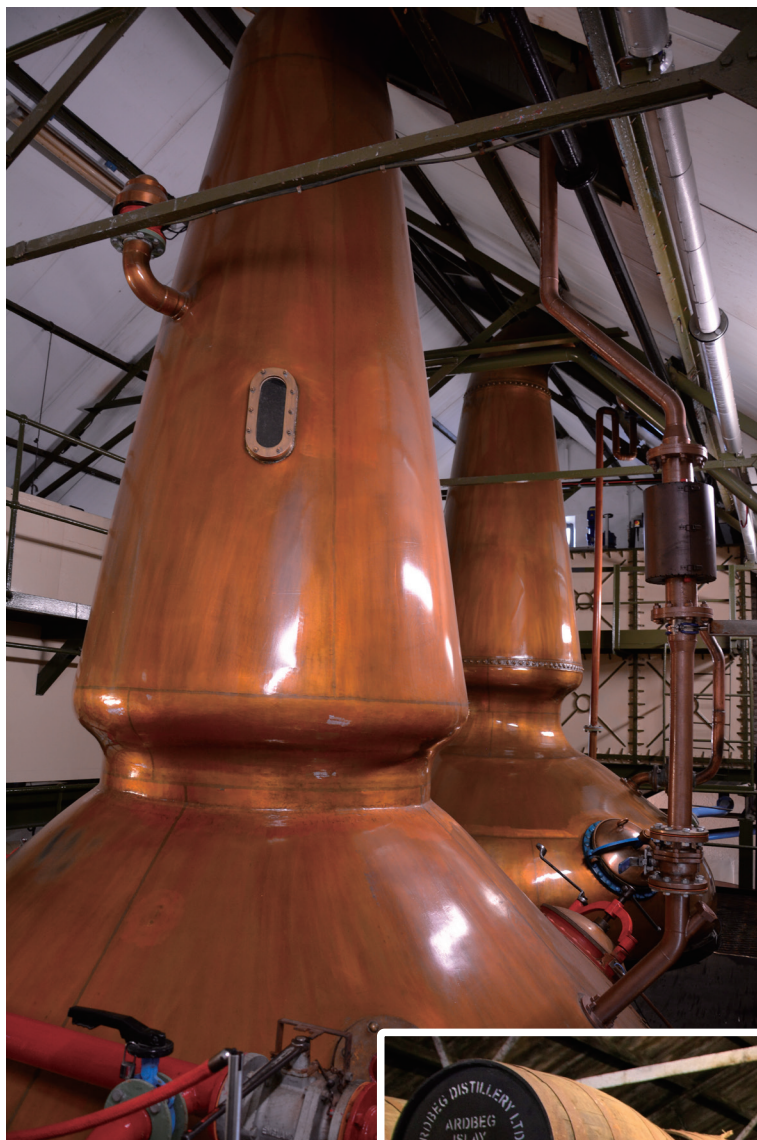
独特のランタンヘッド型のポットスチル。 現在は4基が稼働する。
